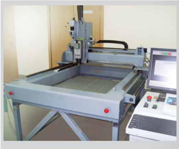
«Снайпер-11» – для изготовления деталей из дерева, модельных материалов и легкообрабатываемых материалов, не требующих высокой точности обработки.
