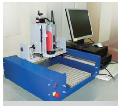
«Снайпер-8» – для изготовления изделий малых форм, сувенирной продукции из дерева и легкообрабатываемых материалов, для декоративной резьбы, также станок может использоваться для обучения персонала (его блок управления может имитировать различные станки).
