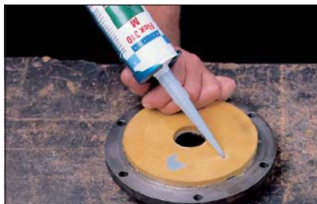
Riparazione di macroporosità in pezzi di poliuretano
