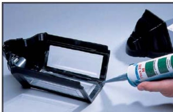
Incollaggio in produzione di lampade
