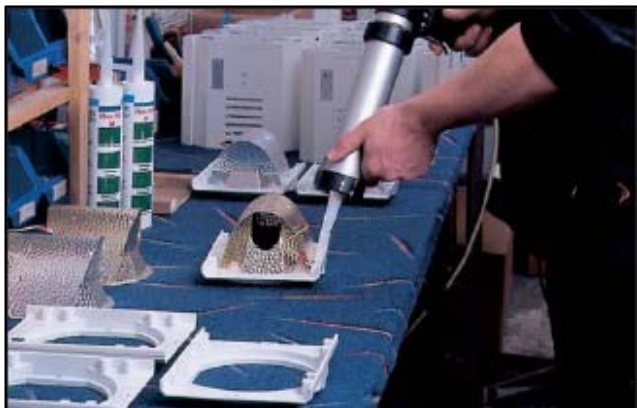
Incollaggio nella produzione di lampade
