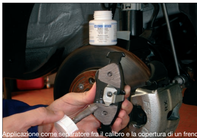
Applicazione come separatore fra il calibro e la copertura di un freno
