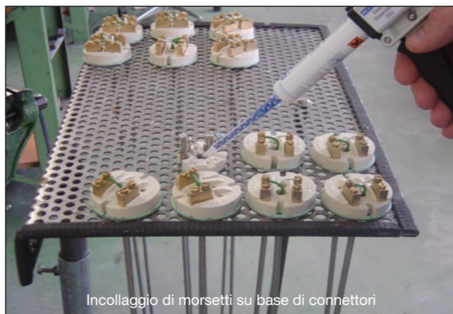
Incollaggio di morsetti su base di connettori
