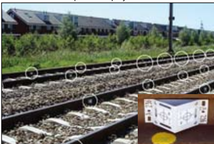
Speed-Flex - Collage de plaquettes de mesurage en mat. synthétique renforcée à la fibre de verre sur des rails de chemin de fer
