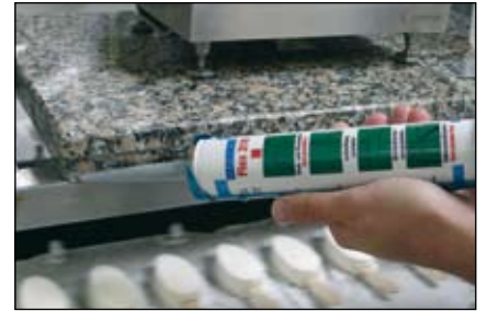
Flex 310 M - Collage d'une plaque de granit sur un cadre en acier inoxydable
