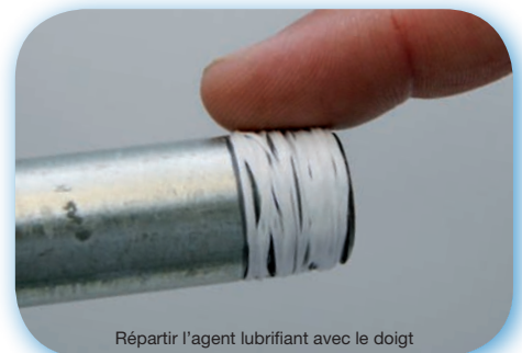
Déposer 2 à 3 gouttes d'agent lubrifiant (intégré dans le fond amovible) sur le fil d'étanchéité - biodégradable
