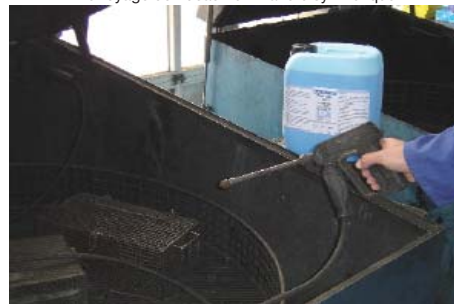
Limpeza y desengrase de partes de motores en máquinas lavadoras de partes metálicas Nettoyage et dégraissage d'éléments du moteur dans laveuses pour des pièces
