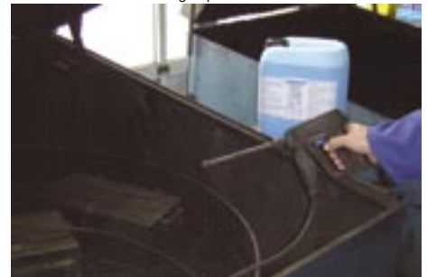
Reinigen und Entfetten von Motorenteilen in Teile-Waschmaschinen Cleaning and degreasing of engine parts in parts' washing machines
