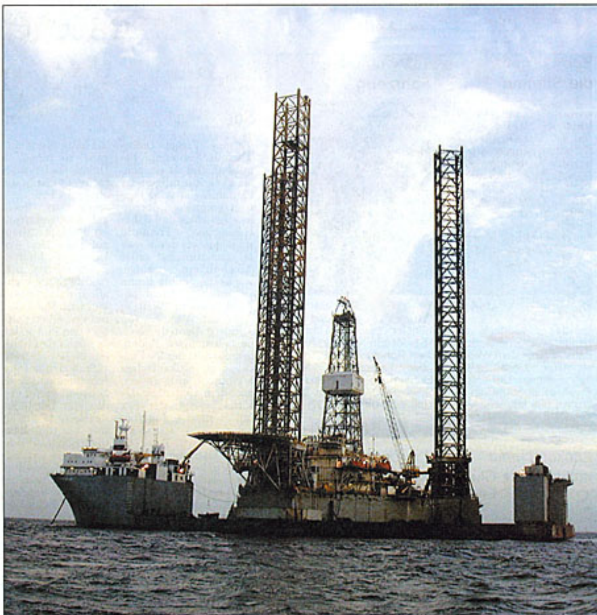
Huckepack auf dem Spezialtransporter „Trans-Ocean-Explorer“ wird die Bohrinsel nach Indonesien transportiert. Die hochgefahrenen drei 120 Meter langen „Beine“ werden während des Transports durch den Weicon-Spezialkleber gesichert.
